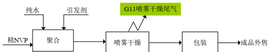
图 4-11 PVPK30 粉生产工艺流程及产污环节图
